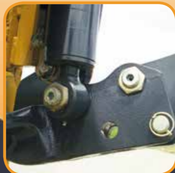
Drei Bolzenstellungen für Multifunktion Zum Hochklappen Zum starr Sperren Als Pendelausgleich für optimale Frontgeräteeinpassung
