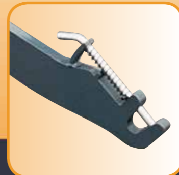
Massive Unterlenkerverriegelung auf Wunsch auch mit Schnellkuppler.
