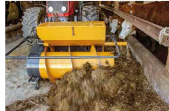
Saubere Futterräumung bei optimaler Auflockerung der Silage.
