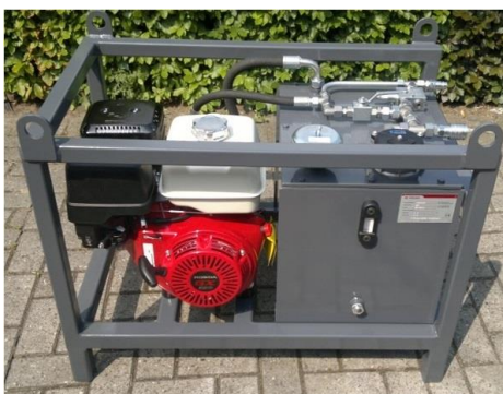
HONDA Benzinmotor mit 9,5 PS
